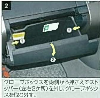
グローブボックスを両側から押させてストッパー(左右2ヶ所)を外し、グローブボックスを取り外す。
