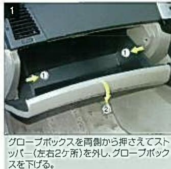
グローブボックスを両側から押させてストッパー(左右2ヶ所)を外し、グローブボックスを下げる。
