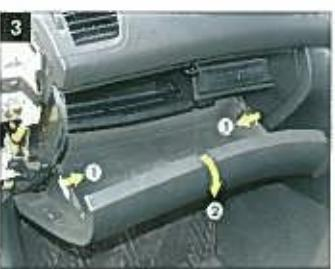
グローブボックスを両側から押させてストッパー(左右2ヶ所)を取り外し、グローブボックスを取り外す。
