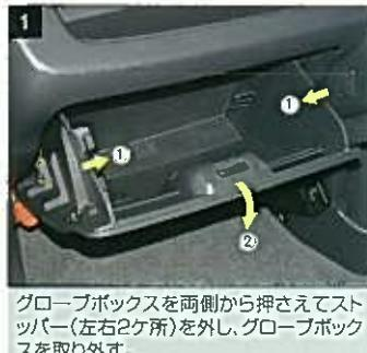
グローブボックスを両側から押させてストッパー(左右2ヶ所)を取り外し、グローブボックスを取り外す。
