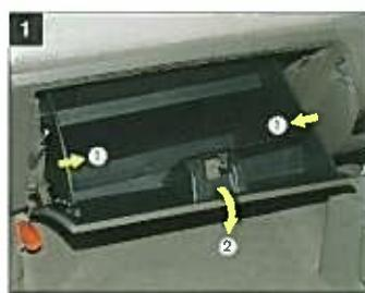
両側からグローブボックスを押させてストッパー(左右2ヶ所)を取り外し、グローブボックスを取り外す。
