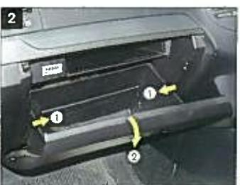
グローブボックスを両側から押させてストッパー(左右2ヶ所)を取り外し、グローブボックスを下げる。
