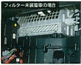
フィルターが装着されていない場合は、斜線部を切り取る。
