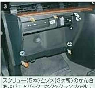
スクリュー（5本）とツメ（3ヶ所）のかん合およびエアバッグコネクタクランプを外し、グローブボックスパネルを取り外す。
