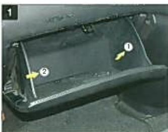
グローブボックスを開き、右側ヒンジを上側に外し、左側をスライドさせてグローブボックスを取り外す。
