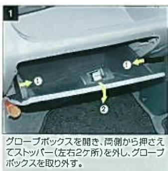
グローブボックスを開き、両側から押させてストッパー(左右2ヶ所)を外し、グローブボックスを取り外す。
