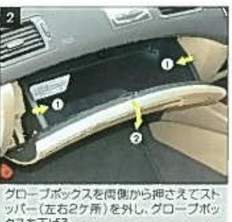
グローブボックスを両側から押さえてストッパー(左右2ヶ所)を外し、グローブボックスを下げる。
