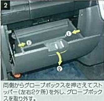
両側からグローブボックスを押させてストッパー(左右2ヶ所)を外し、グローブボックスを取り外す。
