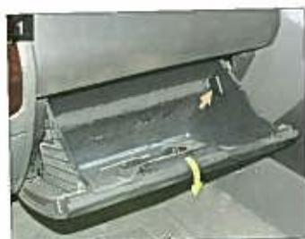
グローブボックスを開き、右側のクリップを取り外し、グローブボックスを取り外す。
