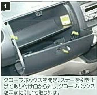
グローブボックスを開き、ステーを引き上げて取り付け口から外し、グローブボックスを手前に引いて取り外す。
