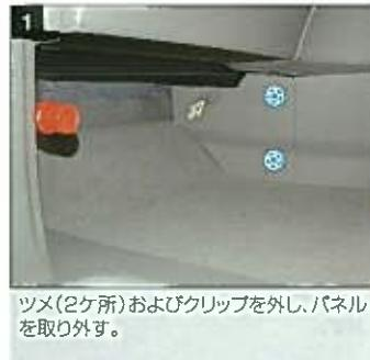
ツメ(2ヶ所)およびクリップを外し、パネルを取り外す。
