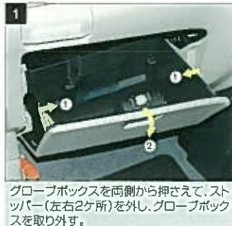
グローブボックスを両側から押させて、ストッパー(左右2ヶ所)を外し、グローブボックスを取り外す。
