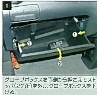
グローブボックスを両側から押さえてストップ(2ヶ所)を取り外し、グローブボックスを下げる。
