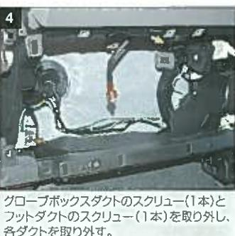
グローブボックスダクトのスクリュー(1本)とフットダクトのスクリュー(1本)を取り外し、各ダクトを取り外す。
