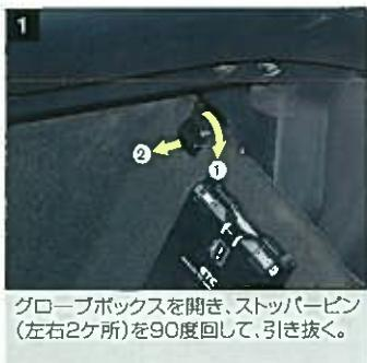
グローブボックスを開き、ストップーピン(左右2ヶ所)を90度回して、引き抜く。
