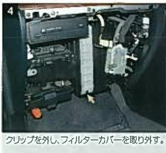
クリップを外し、フィルターカバーを取り外す。
