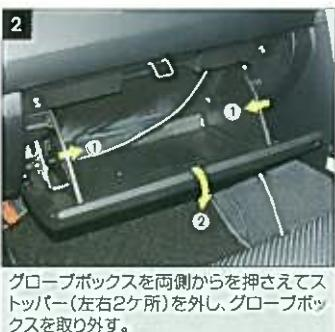
グローブボックスを両側からを押させてストッパー(左右2ヶ所)を外し、グローブボックスを取り外す。
