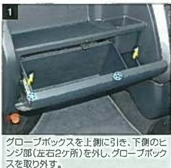
グローブボックスを上側に引き、下側のビンジ部(左右2ヶ所)を外し、グローブボックスを取り外す。
