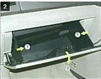
グローブボックスを両側から押さえてストッパー(左右2ヶ所)を外し、グローブボックスを下げる。
