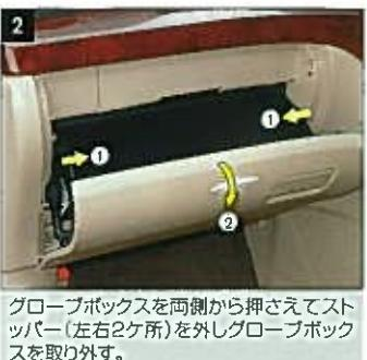
グローブボックスを両側から押させてストッパー(左右2ヶ所)を外しグローブボックスを取り出す。
