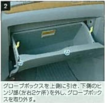
グローブボックスを上側に引き、下側のヒンジ部(左右2ヶ所)を外し、グローブボックスを取り外す。
