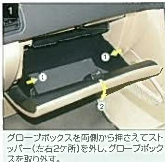
グローブボックスを両側から押させてストッパー(左右2ヶ所)を取り外し、グローブボックスを取り外す。
