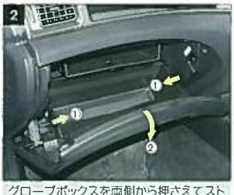
グローブボックスを両側から押させてストッパー(左右2ヶ所)を外し、グローブボックスを取り外す。
