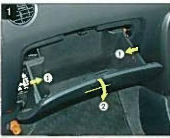
グローブボックスを開き、両側から押させてストッパー(左右2ヶ所)を外し、グローブボックスを取り外す。
