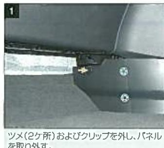
ツメ(2ヶ所)およびクリップを外し、パネルを取り外す。
