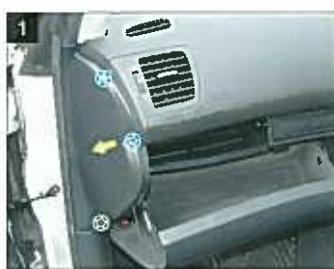
グローブボックスを開き、ツメ(3ヶ所)のかん合を外し、グローブボックス横のパネルを取り外す。
