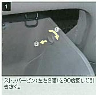
ストッパー・ピン(左右2箇)を90度回して引き抜く。
