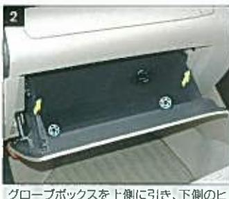
グローブボックスを上側に引き、下側のヒンジ部(左右2ヶ所)を外し、グローブボックスを取り外す。
