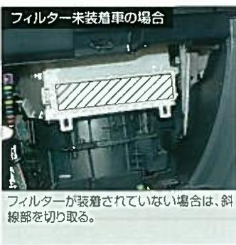
フィルターが装着されていない場合は、斜線部を切り取る。
