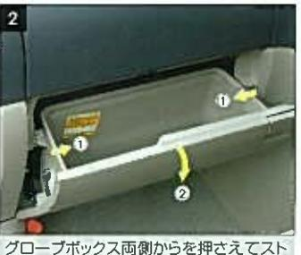
グローブボックス両側から押させてストッパー(左右2ヶ所)を外し、グローブボックスを取り出す。
